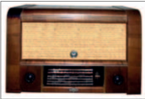
8-Kreis-AM-Großsuper „Stern 9 R 81“ Erster Großsuper von Stern-Radio Rochlitz
