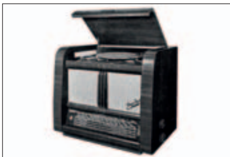
8-Kreis-AM-Großsuper „Stern 7 E 84“ mit Einfachplattenspieler und Magnettongerät
