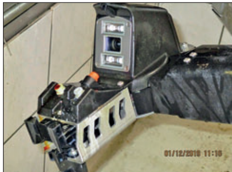
Die Robotereinheit, welche das Euter säubert, das Melkzeug anbringt und nach dem Melken das Euter desinfiziert
