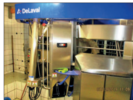
Der Melkroboter im Einsatz, links der Roboterarm, im Melkstand die Milchkuh
